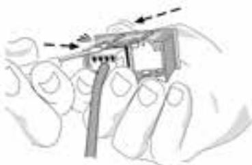
5.2 Действуя отвёрткой, как рычагом, аккуратно оттяните край корпуса розетки, высвобождая фиксатор модуля разъёма.
