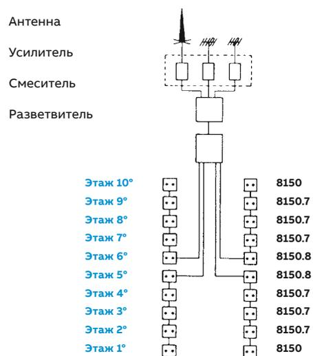
**Пример:** 10 этажей. Этажи разделены на две группы по пять этажей каждая. Розетки распределяются согласно критериям, показанным на схеме подключения MATV для последовательного распределения макс. на 9 этажей. Схема выше может использоваться в зданиях не выше 18 этажей. В зданиях, где этажей больше 18, но меньше 27, необходимо создавать три группы и т. д.
