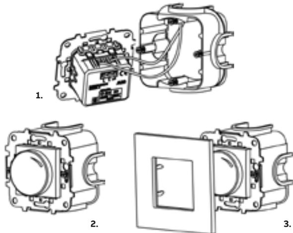
Установите устройство в стену, соблюдая правильное (верх/низ) положение. Соответствующие отметки находятся на задней стороне устройства.
