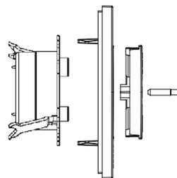
2. В связи с этим, существует 2 способа решить эту задачу: а) Механически обработать (подточить, подрезать) пластиковые фиксаторы (фланцы) рамки и подогнать их по размеру к соответствующим отверстиям в суппорте ТВ-розетки.
