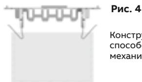
Конструкция и форма лапок таковы, что способствуют лёгкой установке суппорта механизма в коробку.
