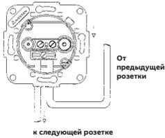
**Важно!** Подключение телевизионных розеток при последовательном распределении должно производиться в соответствии с рисунком слева. Кабель, идущий от предыдущей розетки, подключается к правой клемме, а кабель, идущий к следующей розетке, к левой клемме.
