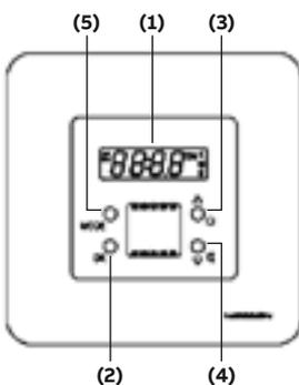
Комнатный терморегулятор оснащён встроенным в корпус датчиком температуры, измеряет температуру воздуха в помещении и изменяет/контролирует её при помощи устройств кондиционирования или отопления.
