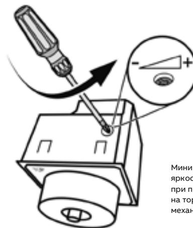
Минимальная уровень яркость устанавливается при помощи потенциометра на торцевой части механизма устройства.
