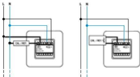
Подключение с системами кондиционирования или отопления стандартное, без сухого контакта.
