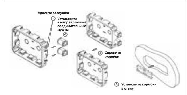
Соединение коробок в полых/ гипсокартонных перегородках
