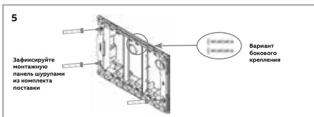
Соединение коробок в бетонных/ кирпичных стенах
