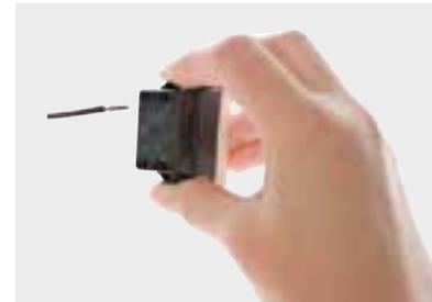
1. Зачистите приблизительно 14 мм провода и установите его в клемму.
