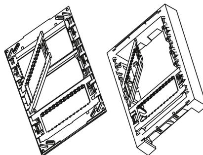
3. Установка механизмов Zenit осуществляется простым нажатием до явного щелчка с обеих сторон механизма.
