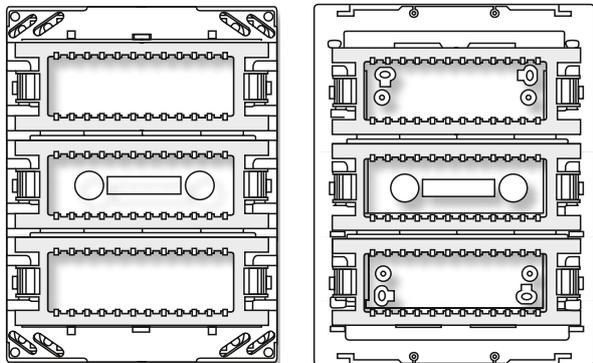
2. Системы централизации комплектуются металлическими суппортами размерности 6М, с петлевым креплением к монтажной панели.
