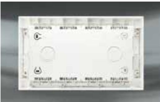
В случае необходимости, мы предусмотрели возможность лёгкого и быстрого соединения нескольких боксов в одну единую конструкцию. Для этого необходимо всего лишь надрезать боковые стороны коробов, извлечь 2 специальных соединителя (сверху и снизу), которые идут в комплекте к боксом и установлены внутри него, развернуть их на 90 градусов и вставить в фиксирующие гнезда второго бокса.
