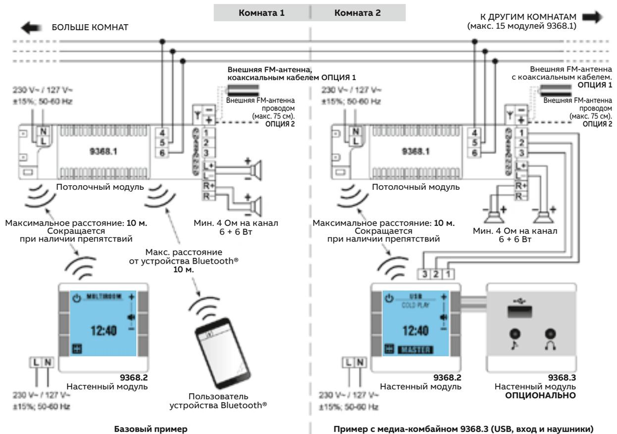
**ПРИМЕЧАНИЕ.** Поскольку данные устройства работают в радиочастотном диапазоне, во избежание помех не следует устанавливать модули с аналогичной рабочей частотой или другое РЧ-оборудование на расстоянии ближе 1 м. Необходимо учитывать, что любые препятствия между устройствами могут существенно сократить дальность их взаимодействия.
